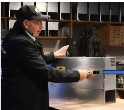
Nachdem Sie die Falle an die Stromversorgung angeschlossen haben, drehen Sie die Verriegelung des Rattenbehälters nach rechts in Position 1 und halten Sie dabei einen Sicherheitsabstand ein, um Verletzungen beim Öffnen und Schließen der Türen und beweglichen Teile zu vermeiden.
